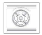
ganz nach links drehen, sodass die kleinen Löcher geschlossen sind (Minimum an Luft, die der Verbrennung zugeführt wird)
